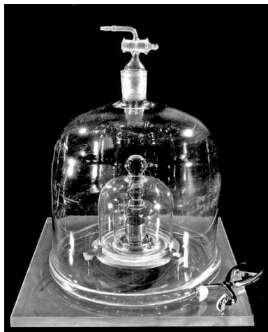
Міжнародний прототип кілограма — циліндр з платино-іридієвого сплаву (90% платина, 10% — іридій). Зберігається в Міжнародному бюро мір і ваги у м. Севр (південно-західне передмістя Парижа, Франція).
